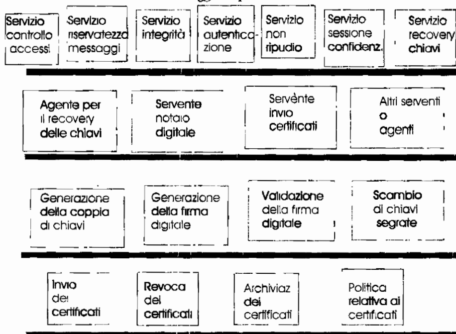
Figura 5.2 Struttura a livelli di una Infrastruttura a chiave pubblica (PKI)
